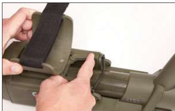
Рычаг фиксации подлокотника в открытом положении
