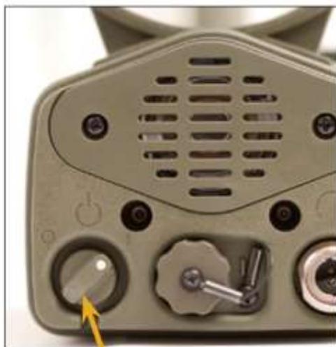
Выключатель питания (показан во включённом положении)
